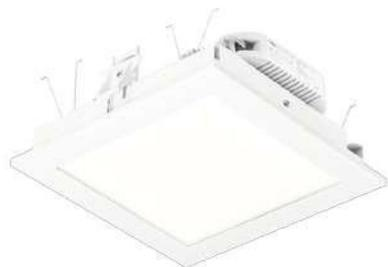
**Características:** Luminária à LED de embutir completa com driver multitemperatura incluso (100 a 250V), Linha Smart, referência Brilia ou equivalente. Fluxo luminoso final de 1800lm; eficiência de até 75lm/W; temperatura de cor 4000K. Conexão por terminal de engate rápido.
